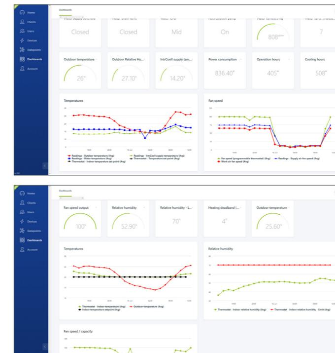
**CLEVERE BETRIEBSARTEN** Der OxyLogic-Controller überwacht die Innen- und Außenbedingungen der Luft, um den komfortabelsten und effizientesten Kühlmodus zu wählen. Wenn das Gerät mit einem Heat Reclaim Modul ausgestattet ist, wird die Belüftung ständig optimiert, wobei die interne Abwärme genutzt wird, um energieeffizientere Vorlauftemperaturen zu erreichen.
